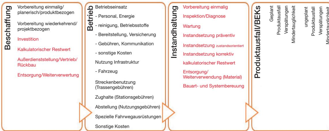
**BILD 3:** Kostenblöcke nach WMP-Methodik<sup>3)</sup> (rot: aktuell berücksichtigte Kostenblöcke bei der Betrachtung des Fahrwegs)
