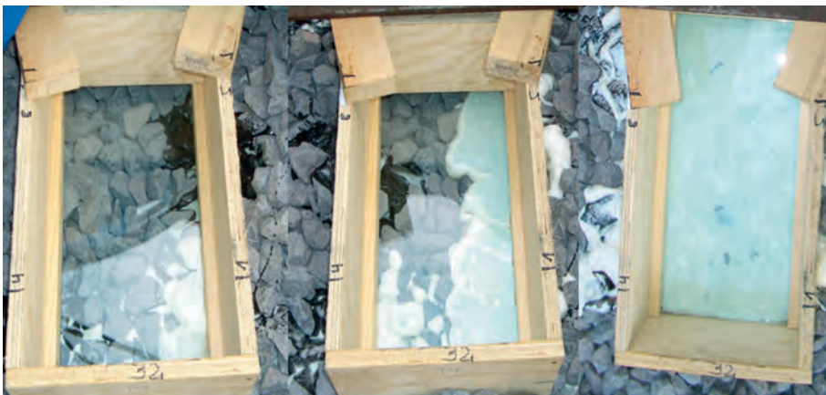
Abb. 2: Das Verschäumergebnis unter der Glas-Schwelle
