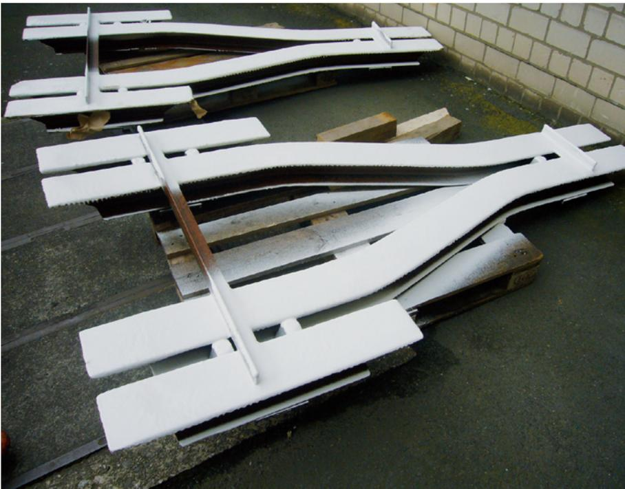
Abb. 7: Y-Stahlschwelle mit Durcoat beschichtet
