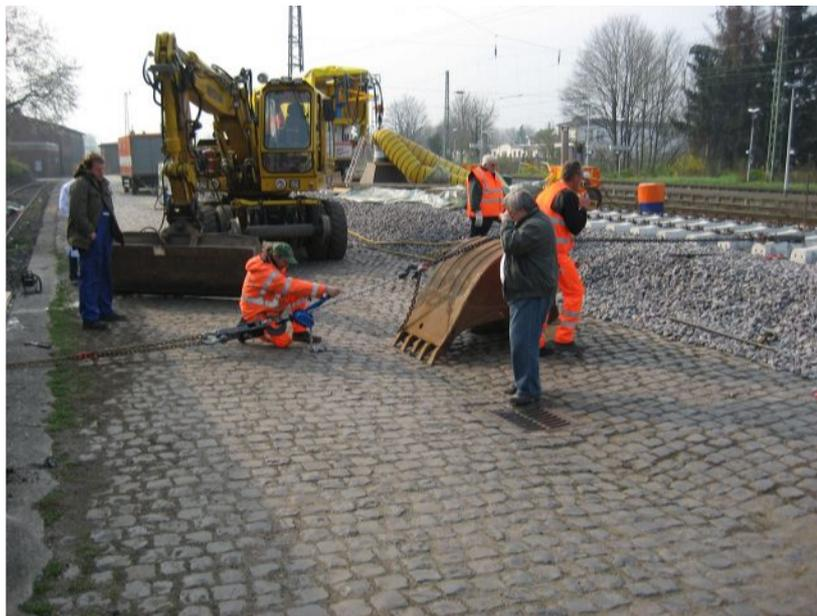
Bild 1: links Festauflager, mittig Kraftmesser und Kettenzug, Umlenkung über Tieflöffel um eine horizontale Krafteinleitung zu Gewährleisten
