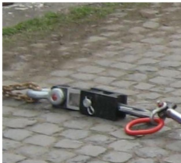
Bild 4: Kraftmessung über digitale Kranwaage Genauigkeit 50N
