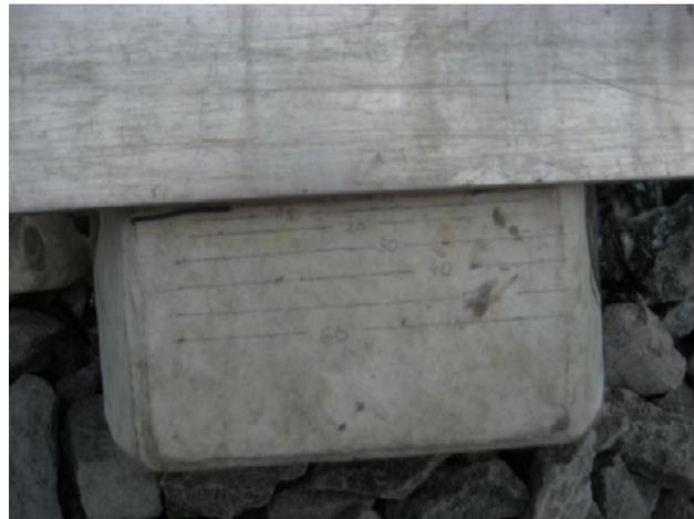
Bild 3: Meßskala auf der Prüfschwelle
