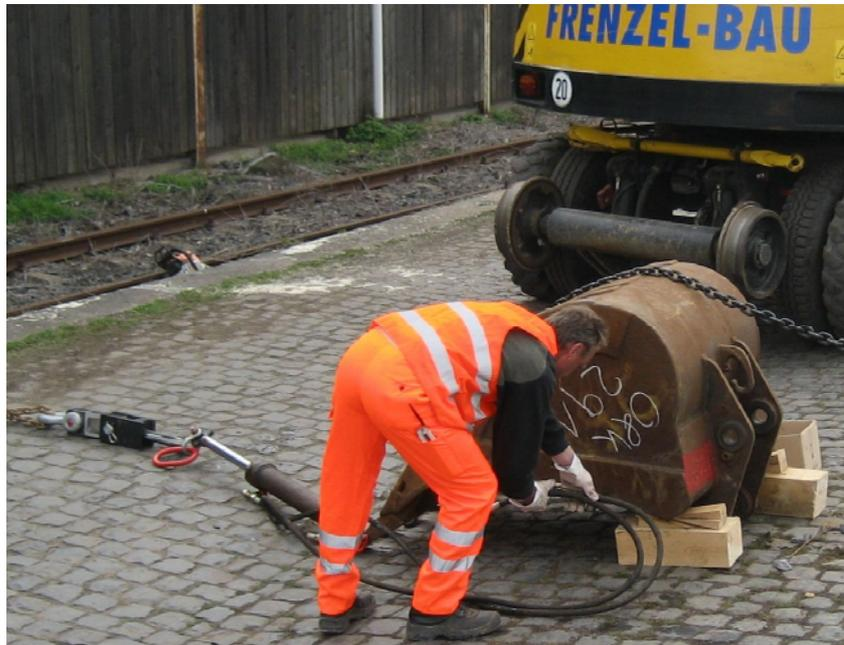
Bild 5: Zur Extremwertermittlung Hydraulikzugzylinder für Messbereich Zwischen 40kN und 60 kN.
