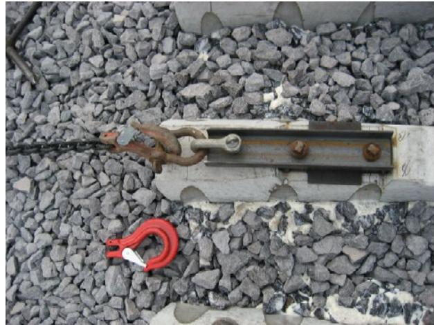
Bild 2: Kräfteinleitung über Schwellenschrauben und Adapter
