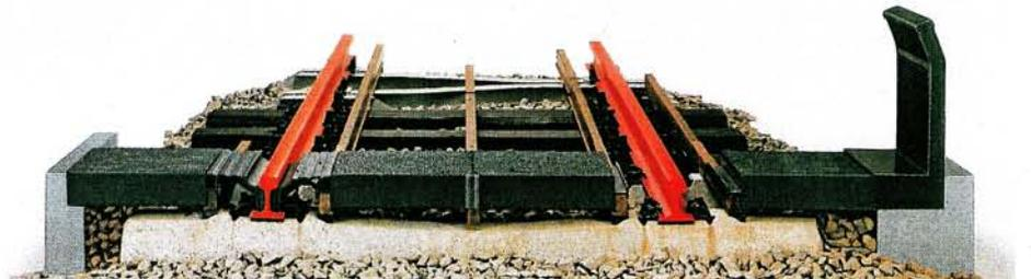
**5** Mit der gleichen kastenförmigen Kassettenplatte ist hier der Gleiskörper in der Bauweise „Rasengleis“ abgedeckt. Sie ist mit offener Seite nach oben verlegt, mit Erde gefüllt und mit Rasen eingesät. Eine Drainageeinrichtung verhindert Nässestau. Der Rasen ist auf Wunsch vorkultiviert.
