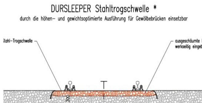
Bild 1: Oberbauquerschnitt mit DURSLEEPER
